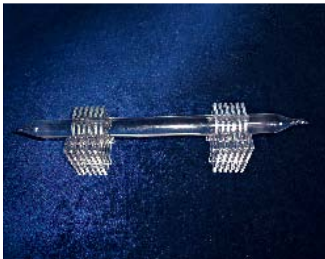
Преформа для вытяжки многомодового ОВ, изготовленная на опытном участке завода "Оптическое Волокно Системы"
